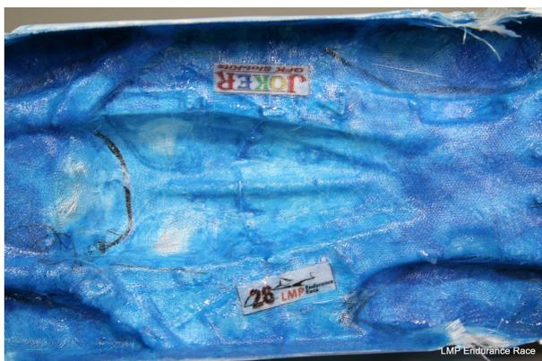
Das überstehende Laminat darf bis zu den Formkanten (rot markiert) abgeschliffen werden. Front, Seitenscheiben und Radläufe geöffnet und das Armaturenbrett entfernt werden. Das Heck darf nicht ausgefräst oder geöffnet werden (ausgenommen Bohrungen für Beleuchtung). Die Front darf mit einer Frontlippe aus CFK/GFK verstärkt werden.
